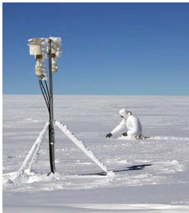
Amostragem simultânea de ar e da neve em condições ultralimpas. Esses estudos são essenciais para quantificar o transporte de poluentes da América do Sul para a Antártica. Fotografia: Jefferson C. Simões (UFRGS).
